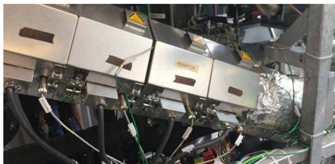
Der Reaktor ist eines der Herzstücke der Recycling-Module. Hier wird der gemischte Kunststoffabfall unter Sauerstoffausschluss in kontinuierlichem Prozess auf ca. 400 Grad erhitzt.
