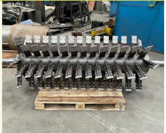
Robuste Konstruktion der Rotoren, die den Kunststoffabfall im Trommelsieb befördern.
